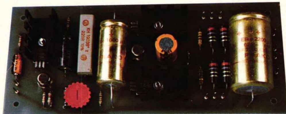
Afb. 1 De complete printbouw. Bij deze prototype-uitvoering was weerstand R4 opgebouwd met twee afzonderlijke waarden van 12\Omega (parallel).
